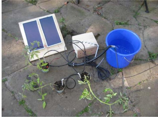
begießen. Wird die Erde nun also trocken, schaltet das Relais durch, wodurch sich dann der Stromkreis an der Pumpe schließen kann und die Pflanze im Endeffekt bewässert wird. Ist die Erde dann wieder feucht genug, schaltet die Schaltung um und es leuchtet nur noch die gelbe oder grüne LED, je nach dem, wie feucht die Erde geworden ist.
